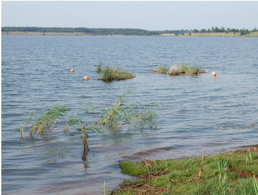
Abb. 10: Die Versuchsanlage „lebende Inseln“, rechts im Bild die schwimmenden Gabionen, links im Bild eine bepflanzte Pflanzenträgermatte (07/2003)
